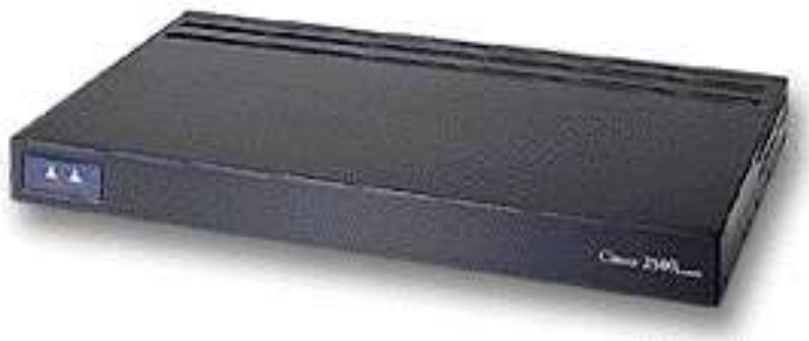
Enrutador marca Cisco 2500 series
