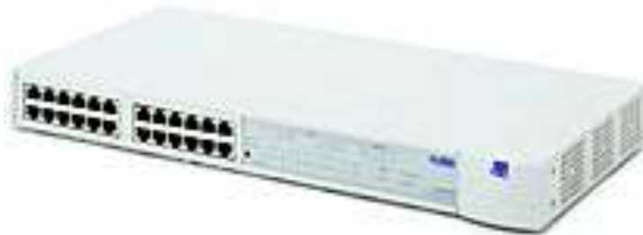
Hub marca 3Com modelo Superstack II 24 puertos
