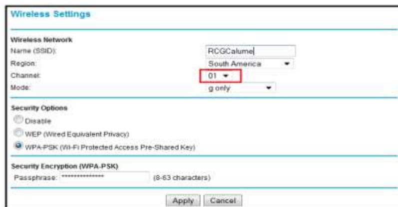
Configuración de la red de control RCGCalume en canal 1 fuente el autor
