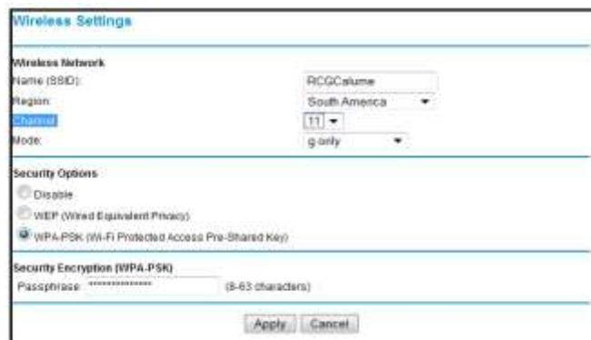
*Configuración de la red de control RCGCalume en canal 11 fuente el autor*
