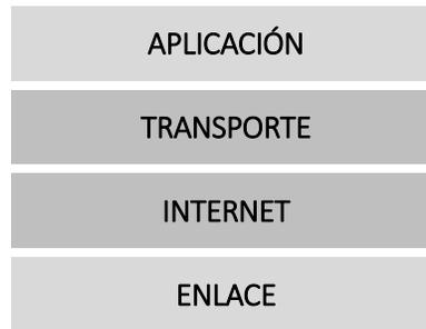
El **TCP/IP** es la base de Internet, y sirve para **comunicar** todo tipo de dispositivos, computadoras que utilizan **diferentes sistemas operativos**, minicomputadoras y computadoras centrales sobre redes de área local (**LAN**) y área extensa (**WAN**). **TCP/IP** fue desarrollado y demostrado por primera vez en 1972 por el departamento de defensa de los Estados Unidos, ejecutándolo en **ARPANET**, una red de área extensa del departamento de defensa (Alfinal.com , 2015).
