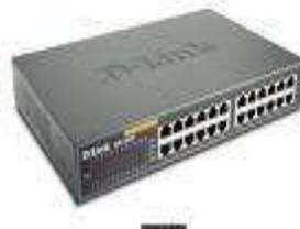
A primera vista los switches parecen a menudo similares a los hubs. Tanto los hubs como los switches tienen varios puertos de conexión, dado que una de sus funciones es la concentración de conectividad (permitir que varios dispositivos se conecten a un punto de la red). La diferencia entre un hub y un switch está dada por lo que sucede dentro del dispositivo.
