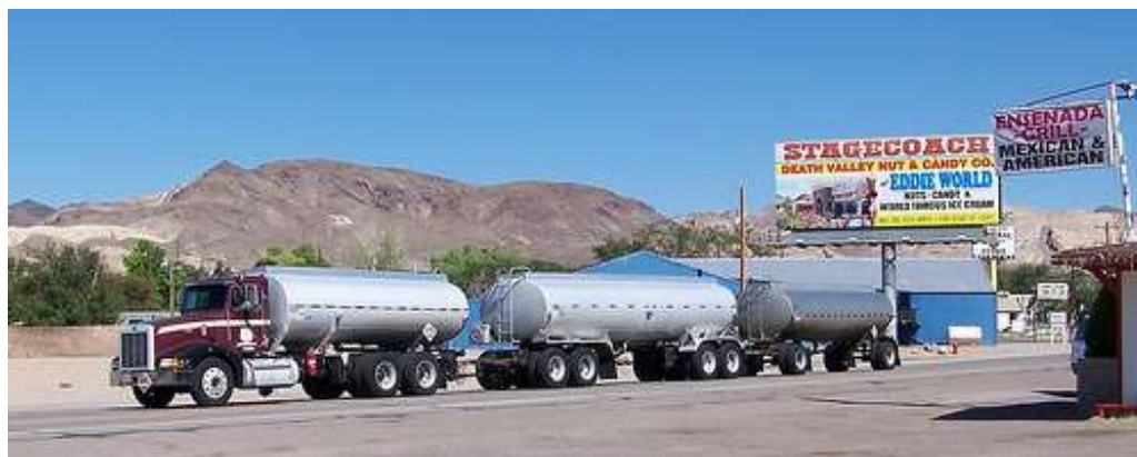
Figura 19. Camión con tráiler tipo tanque, para el transporte de líquidos Figura tomada de http://www.flickr.com
