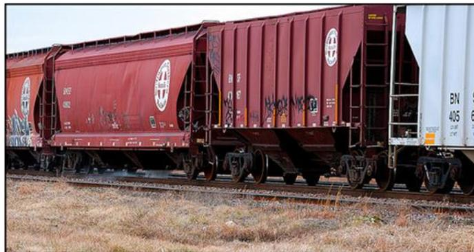
Figura 41. Tolva granelera para materiales de minería
