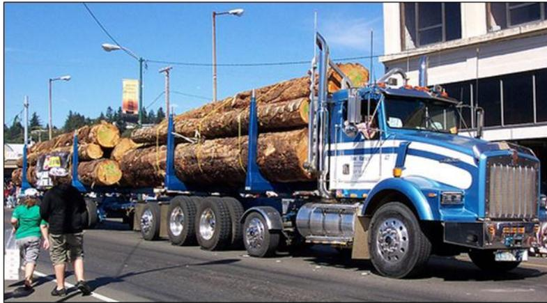
Figura 37. Camión con tráiler adaptado para el transporte de maderas
