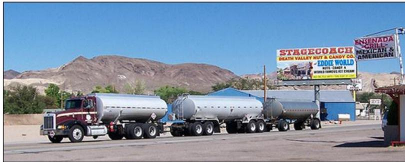
Figura 36. Camión con tráiler tipo tanque, para el transporte de líquidos
