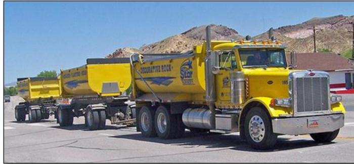
Figura 35. Camión con tráiler tipo tolva
