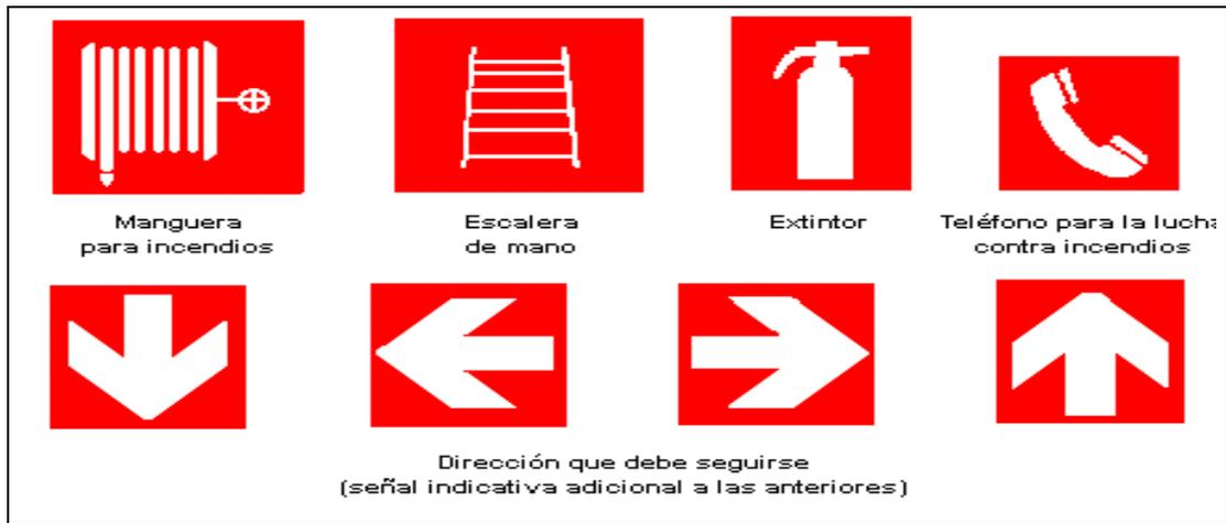
Fig. 55: Algunas señales de equipos de lucha contra incendios. Forma: rectangular. Color: rojo. Fuente: Norma iram 10005- parte 1
