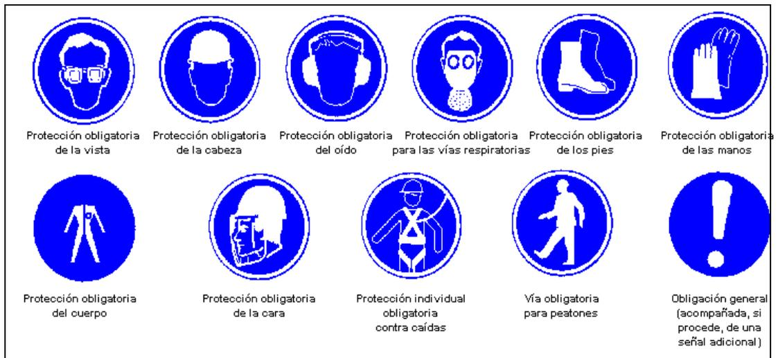
Fig. 54: Algunas señales de obligación. Forma: circular. Color: azul. Fuente: Norma iram 10005- parte 1
