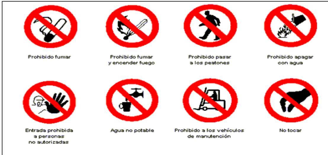
Fig. 53: Algunas señales de prohibición. Forma: Circular. Color: Rojo. Fuente: Norma iram 10005- parte 1
