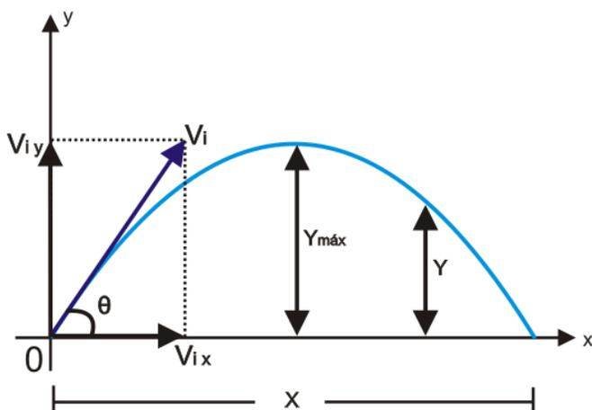
Utilizando las funciones Seno y Coseno deducimos las componentes de la velocidad.
