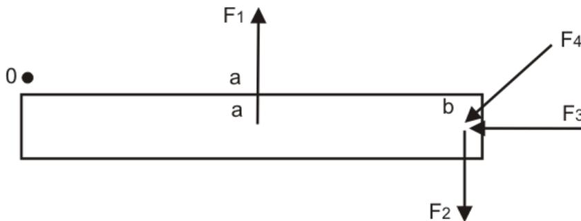
Se define el torque  $T$  de una fuerza  $F$  que actúa sobre algún punto del cuerpo rígido, en una posición  $r$  respecto de cualquier origen O, por el que puede pasar un eje sobre el cual se produce la rotación del cuerpo rígido, al producto vectorial entre la posición  $r$  y la fuerza aplicada  $F$ .
