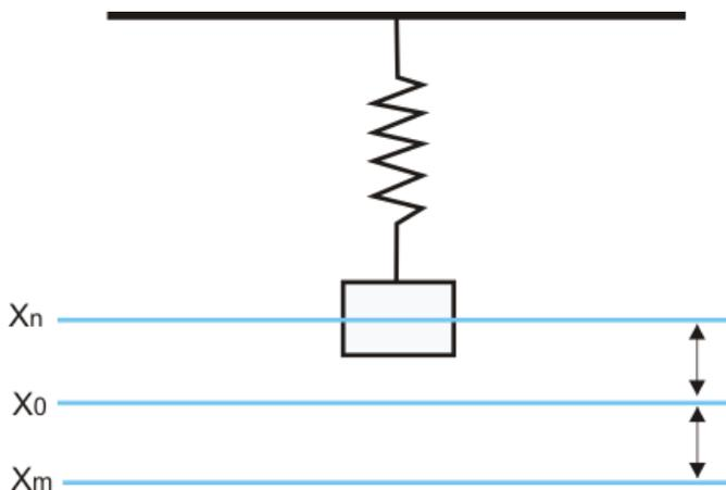
El movimiento armónico simple es un tipo de movimiento vibratorio causado por la proyección de un movimiento circular uniforme en una recta lineal.
