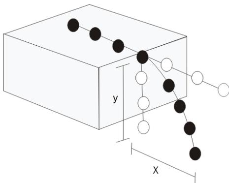
En el eje x tenemos un movimiento rectilíneo uniforme (Velocidad constante)
