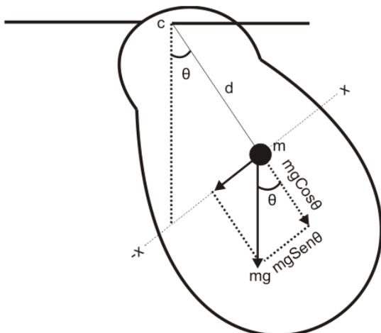
Tenemos en el péndulo físico un torque restaurador equivalente a  $\tau_C = Fx_d$
