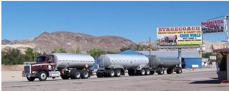
Figura 19. Camión con tráiler tipo tanque, para el transporte de líquidos
